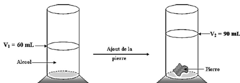
2. En travaux pratiques, un groupe d'élève désire déterminer la densité d'une pierre et celle d'un alcool. Ils font des mesures schématisées ci-contre :
